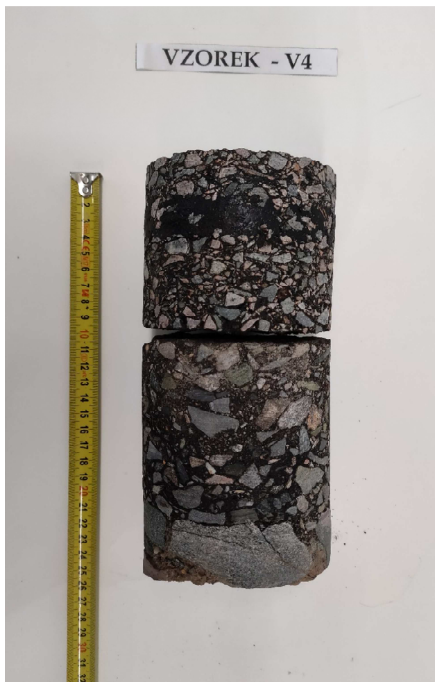
Obr. 8 - Jádro vývrtu Vzorek – V4 (laboratoř).
