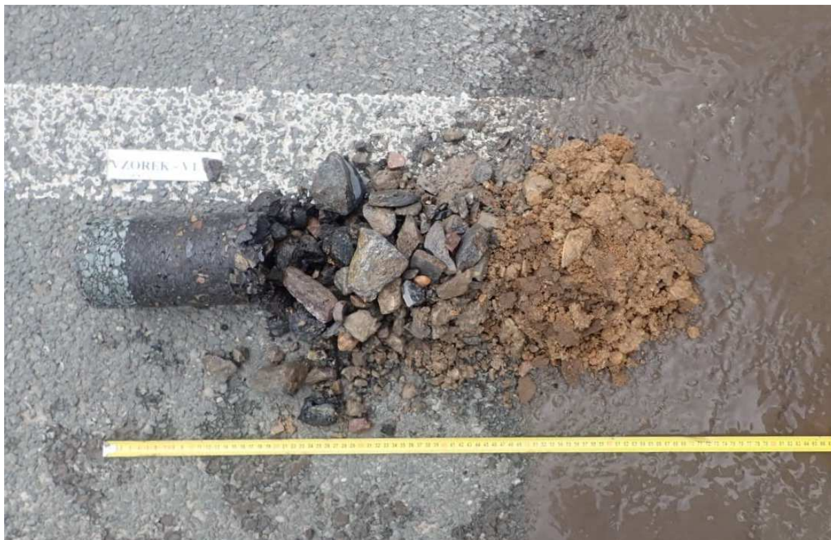
Obr. 1 - Jádro vývrtu Vzorek – V1 (in situ).
