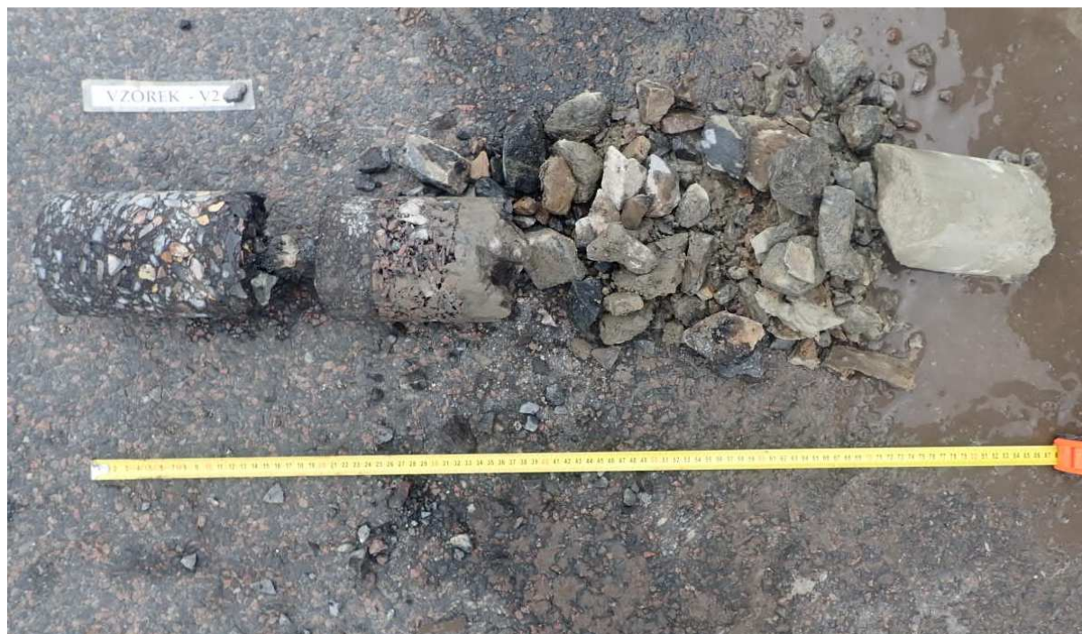
Obr. 3 - Jádro vývrtu Vzorek – V2 (in situ).
