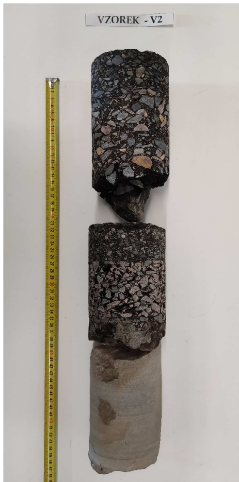
Obr. 4 - Jádru vývrtu Vzorek – V2 (laboratoř).
