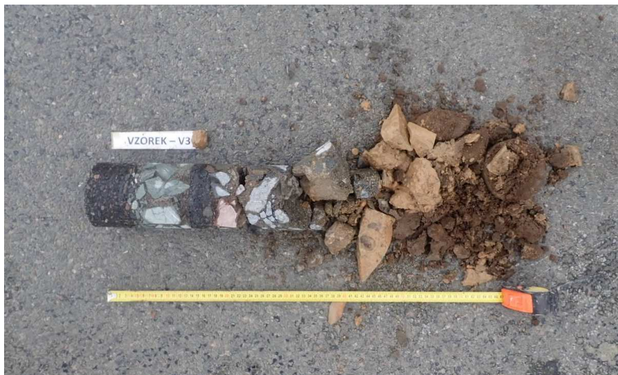
Obr. 5 - Jádro vývrtu Vzorek – V3 (in situ).
