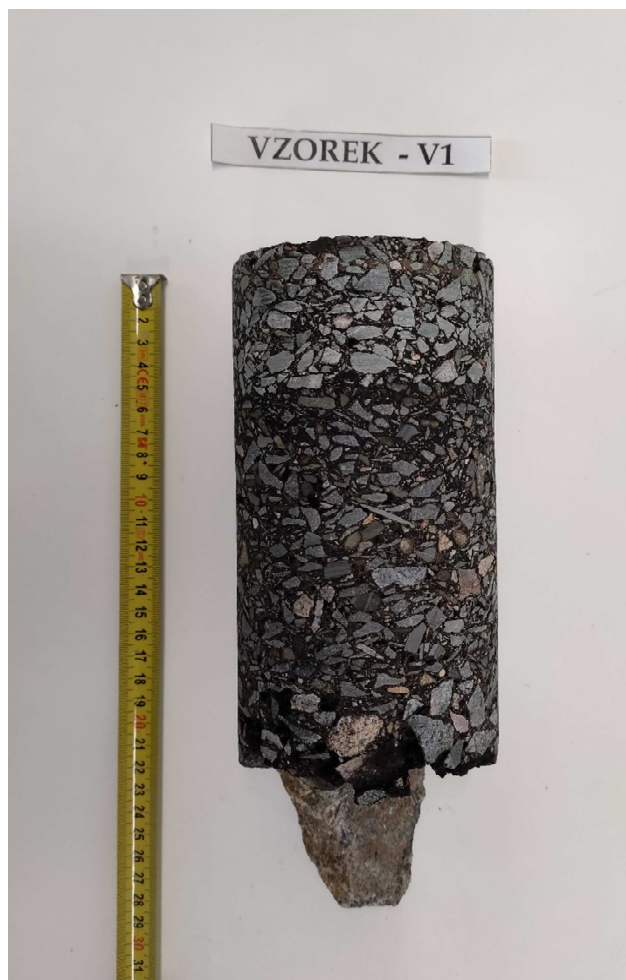
Obr. 2 - Jádru vývrtu Vzorek – V1 (laboratoř).
