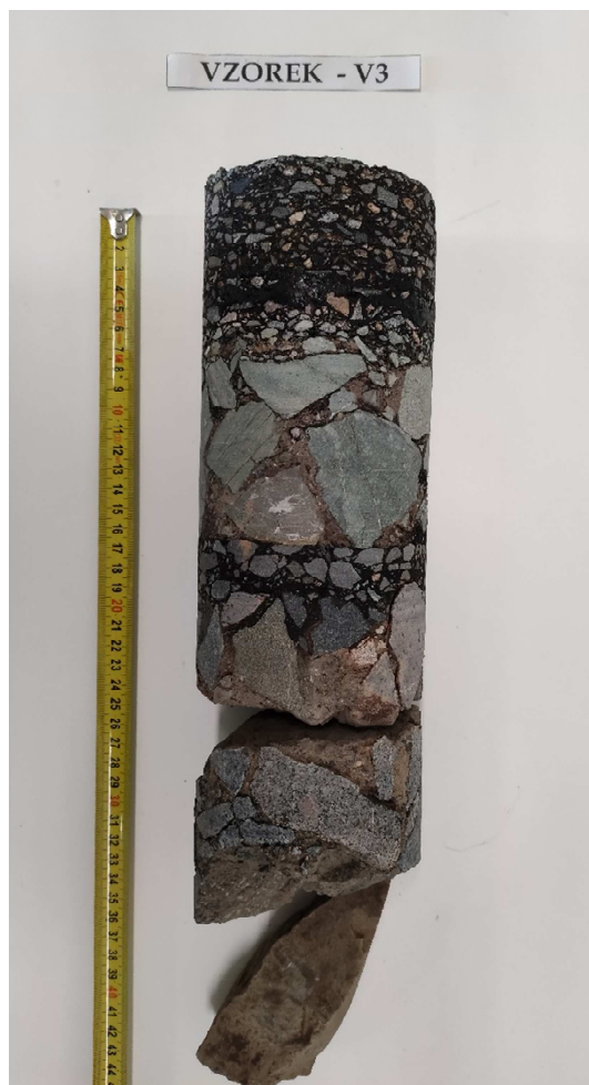
Obr. 6 - Jádro vývrtu Vzorek – V3 (laboratoř).
